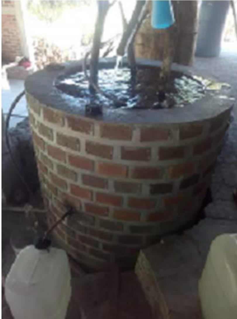
*Figura 28 Destilado de mezcal de Agave angustifolia y separación de alcohol y agua.*
