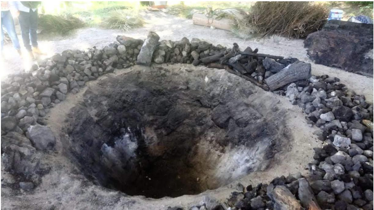
*Figura 14 Horno para el proceso de cocimiento de las piñas, para la elaboración del mezcal con capacidad de ocho toneladas.*
