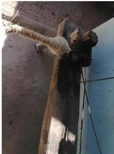
*Figura 2 Trompos de izote hechos con la ayuda de un banco y rueda.*
