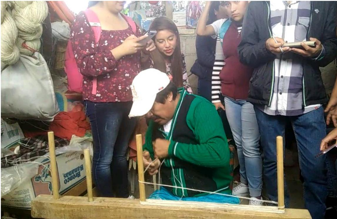
Figura 57 Fibra entrelazada y puesta en dos varas por pares, se percata el cruce formado por el urdidor y dividido por las mismas.
