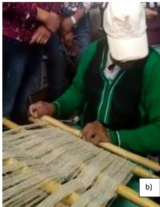
*Figura 59 a) Telar de cintura para el tejido de morral de Yucca treculeana y b) Telar compuesto por varas de coahulote.*
