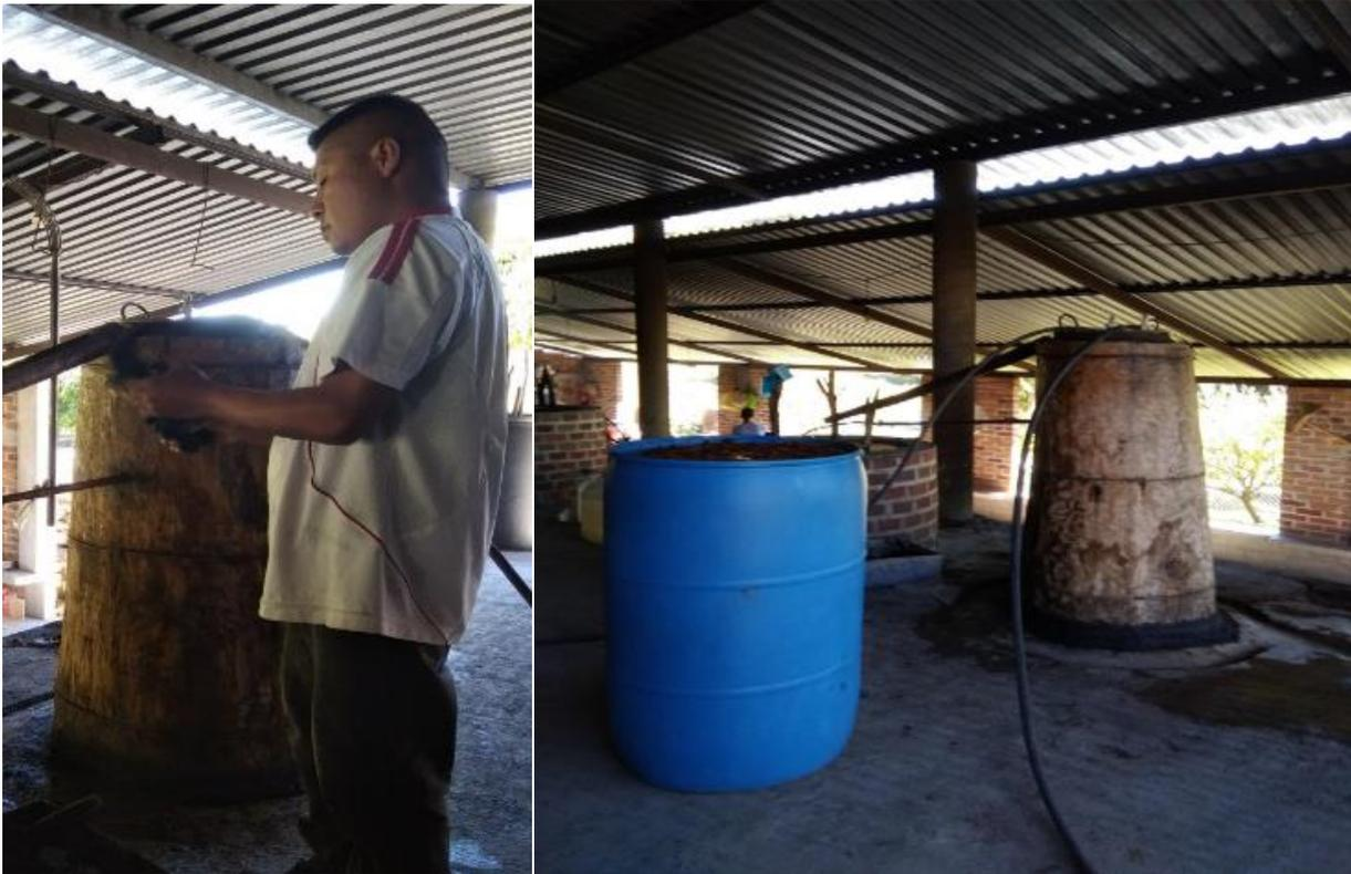
*Figura 25 Cascomite elaborado por las manos de los productores de mezcal, hecho con madera de árbol de colorín, sellado con lodo y llenado de agua para el destilado de *Agave angustifolia*.*
