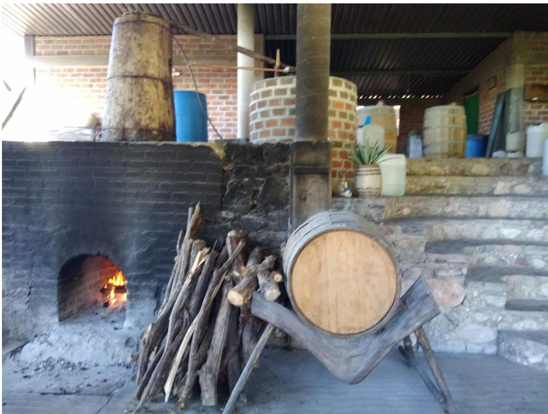
*Figura 24 Estructura tradicional para el destilado de Agave angustifolia para la obtención del mezcal.*
