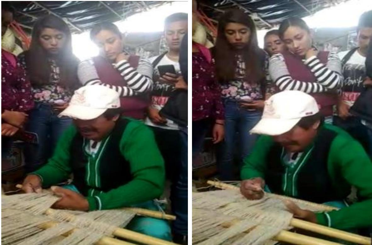
*Figura 61 Paso a paso de preparación del telar, para formar el tejido de cruz.*
